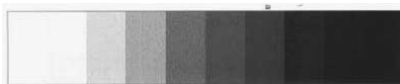
Seleção de zonas de contraste de um filme Kodak T-Max 400. O cinza médio corresponde à zona V.
